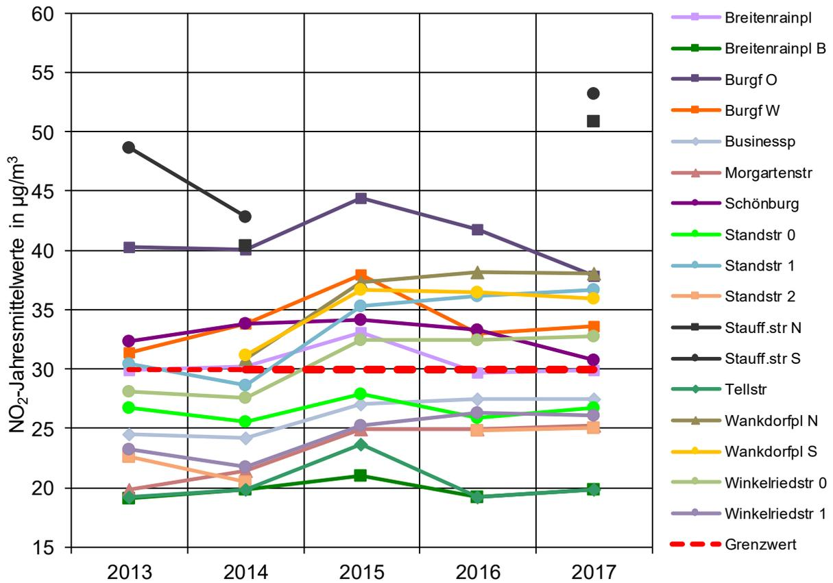
Abbildung 2: Darstellung der Jahresmittelwerte an den **Passivsammlerstationen** des AfU von 2013 – 2017.
